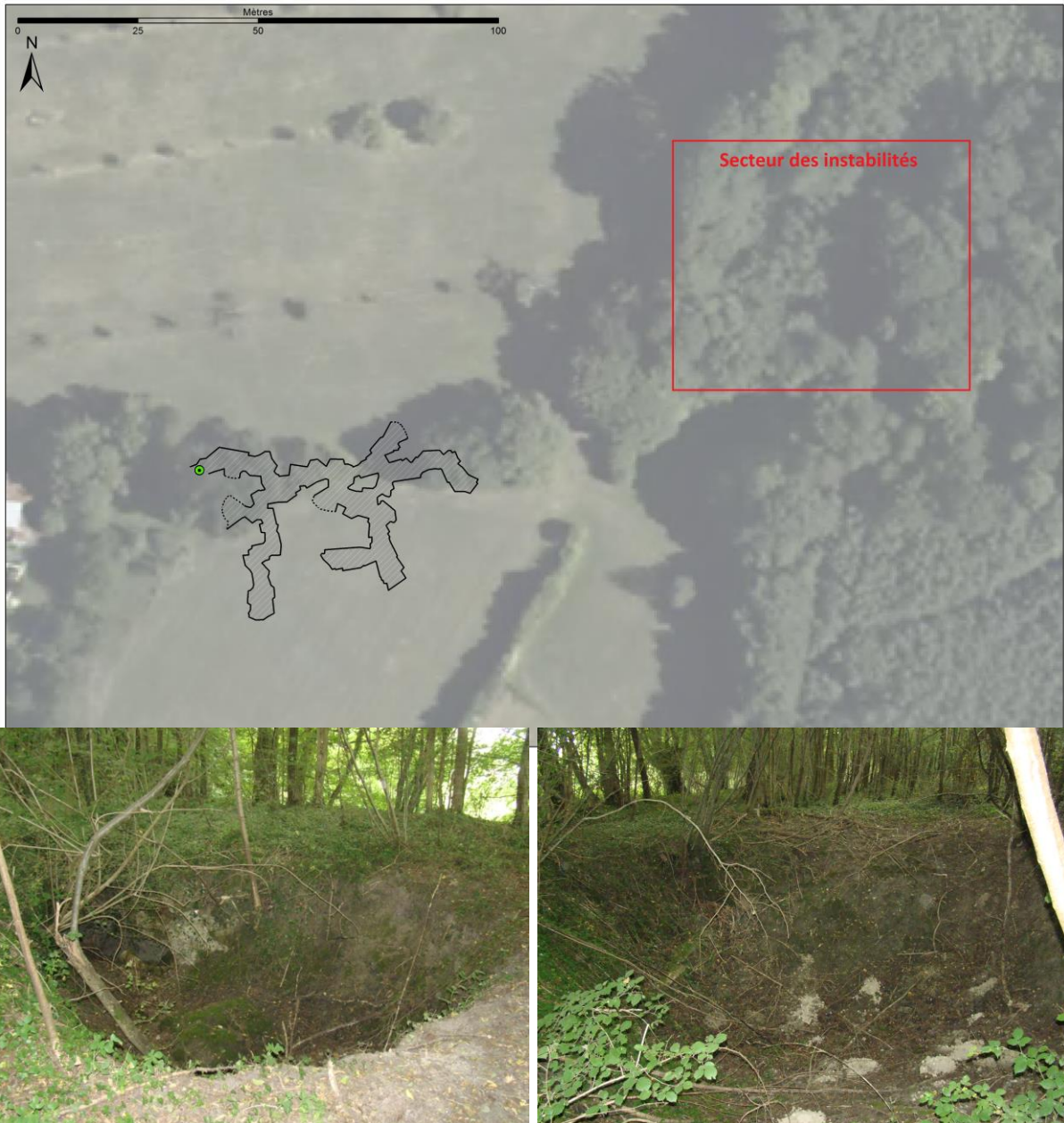
Illustration 10 : Effondrements visibles à 70 m à l'est de l'entrée de la carrière souterraine, en amont d'un ancien front de taille
